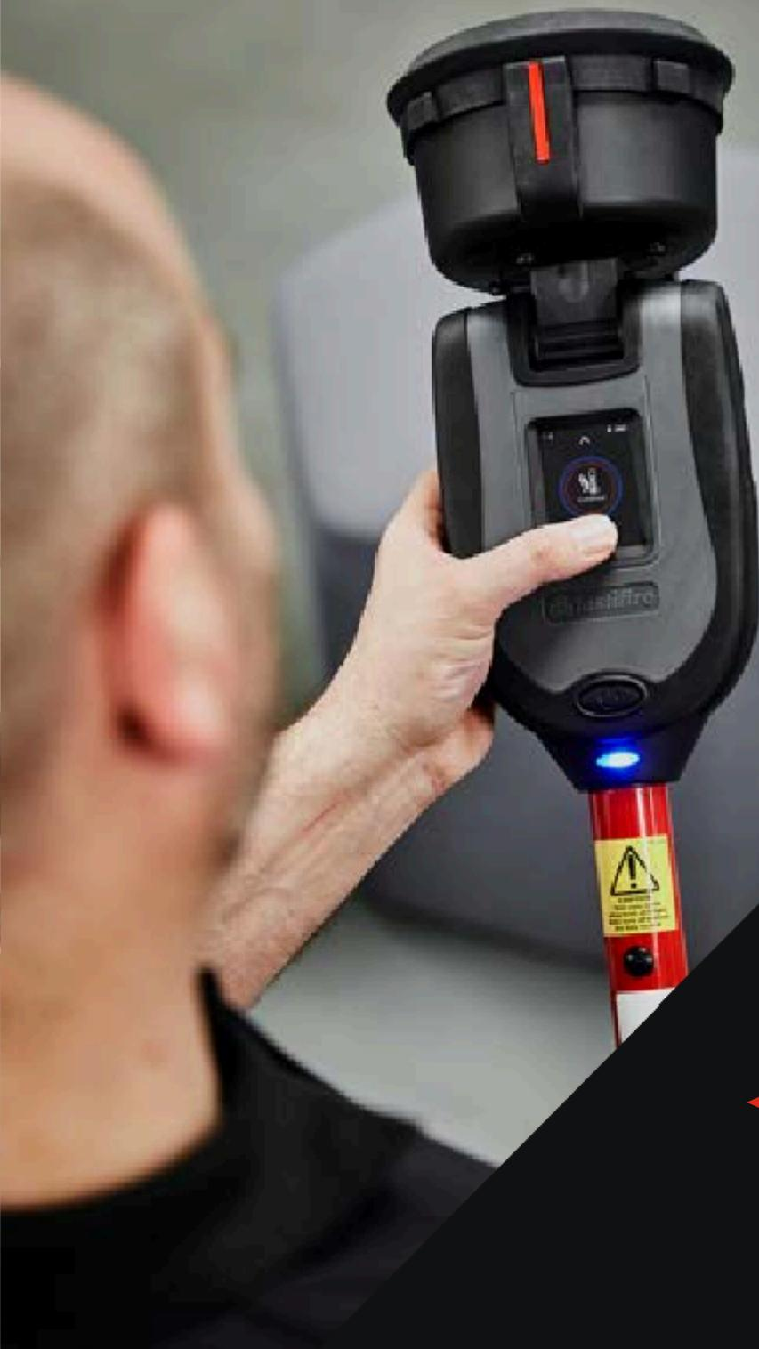
◀ **All-in-One-Prüfung von Rauch- und Wärmemeldern, einschließlich: Prüfmodi für Rauch, Hitze, Hi-Heat sowie für kombinierte, sequenzielle und verzögerte Starts**
