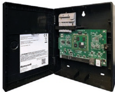
Anwendungsbeispiel: CLSS mit optionalem LTE-Mobilfunk-Modul (aufgesteckt auf der CLSS-Platine)
